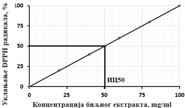
Slika 2. Primer određivanja zavisnosti procenta uklanjanja DPPH radikala od koncentracije biljnog ekstrakta i određivanje IC 50 vrednosti grafičkom interpolacijom
